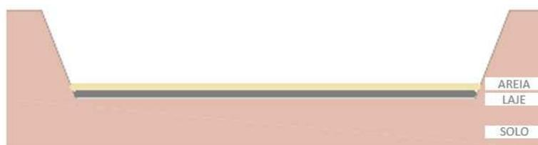
4. Colocar o equipamento totalmente vazio em cima da almofada de areia e ir enchendo de água faseadamente com camadas de 20/30cm à medida que se efetua o enchimento externo lateral com argamassa entre o equipamento e o aterro até chegar ao nível das tubagens. Deverão ser respeitados os tempos de cura da argamassa.
